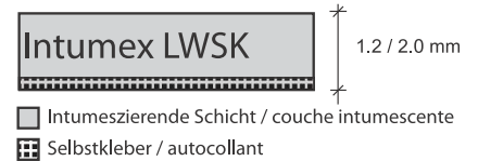
Schichtenaufbau / Structure de couches
